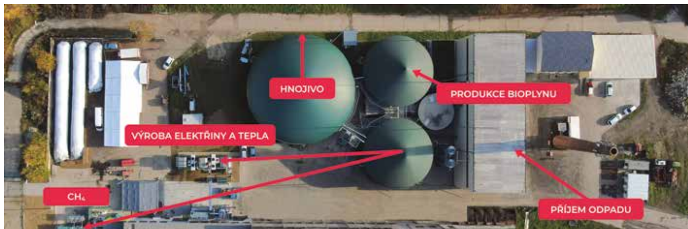
Postup energetického zpracování odpadu v EFG Rapotín BPS.
